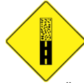
İLERİDE ASFALT YÜZEY SONU
